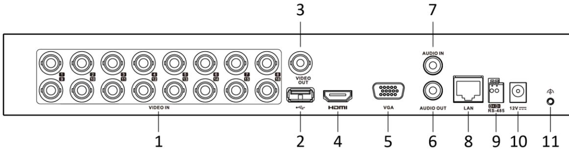
\* : El panel posterior de iDS-7204HQHI-M1/FA proporciona 4 interfaces de entrada de video. El panel posterior de iDS-7208HQHI-M1/FA proporciona 8 interfaces de entrada de video.
